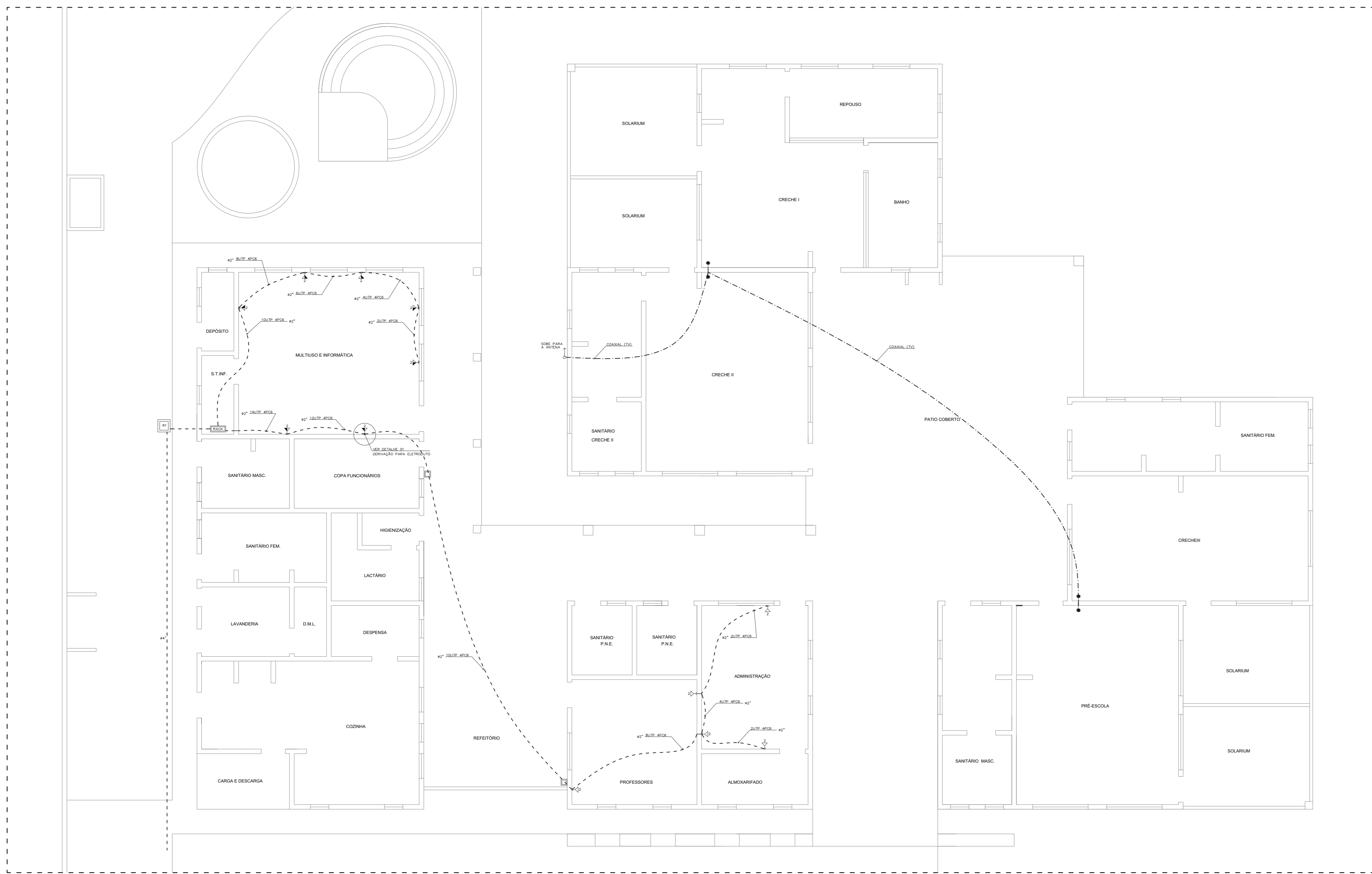
PLANTA DE INSTALAÇÃO DE CABEAMENTO ESTRUTURADO ESCALA 1:75
