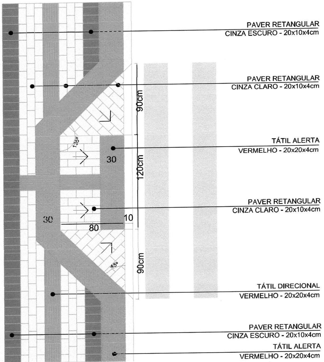
**Obs:** Em todas as esquinas de quadras ou em faixas de pedestres devem ser construídas Rampas de Deficiência CF. NBR 9050/2004
