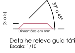
Detalhe relevo guia tátil Escala: 1/10 O piso guia tátil deverá atender as normas da ABNT Resistência à compressão Fck > 35 MPa
