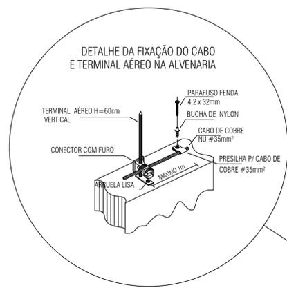
DETALHE DA FIXAÇÃO DO CABO E TERMINAL AÉREO NA ALVENARIA
