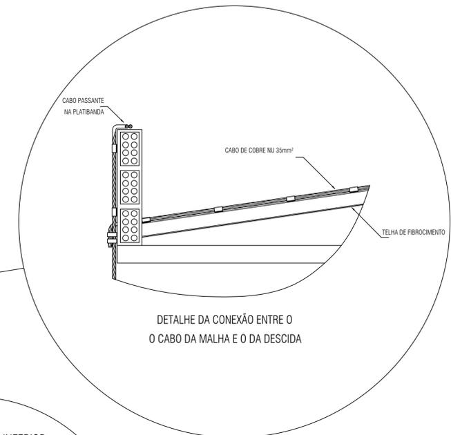
DETALHE DA CONEXÃO ENTRE O O CABO DA MALHA E O DA DESCIDA
