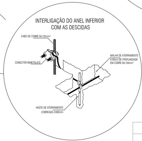
INTERLIGAÇÃO DO ANEL INFERIOR COM AS DESCIDAS
