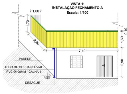
EXECUTAR FACHADA COM INSTALAÇÃO DE PAINÉL METÁLICO, ESTRUTURADO EM TRAMA DE AÇO E COM FORRO EM CHAPA METÁLICA, MEDIANTE FIXAÇÃO DE CALHA.
