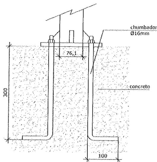
Toda a estrutura em metal (poste, suporte para câmera, chumbador, parafusos, porcas, arruelas, deverão ser pintadas com tinta branca esmalte sintético, sobre fundo anti-corrosão a fim de evitar o enferrujamento da estrutura e proteção da mesma.
