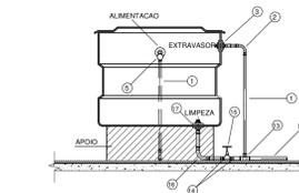
INSTALAÇÃO DE CAIXA D'ÁGUA CORTE TRANSVERSAL
