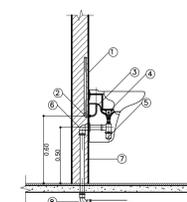
LAVATÓRIO COLUNA SUSPensa VISTA LATERAL
