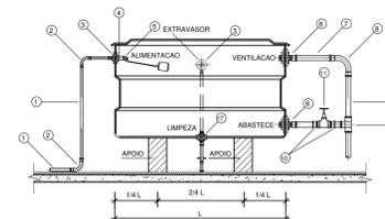
INSTALAÇÃO DE CAIXA D'ÁGUA CORTE LONGITUDINAL
